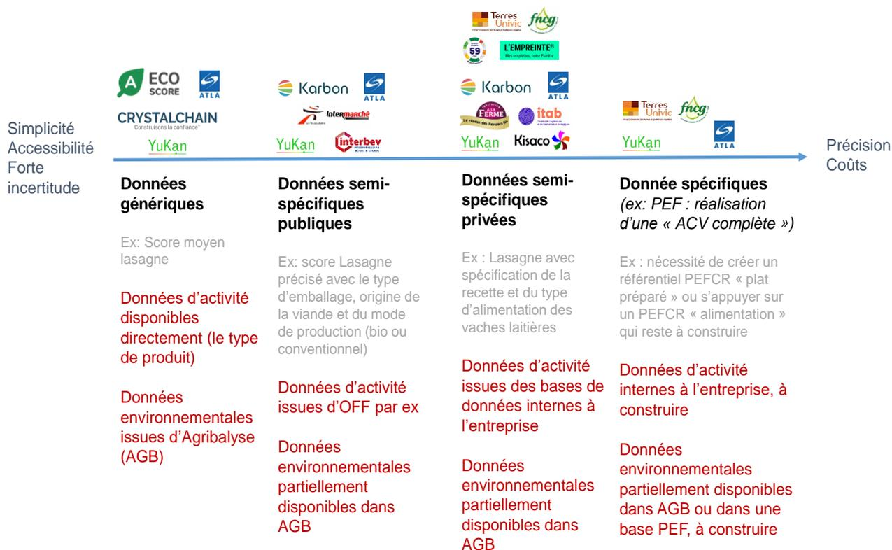
Figure 18 : synthèse des approches utilisées par les projets de l'Expérimentation en termes de données utilisées pour l'ACV (hors bonus-malus)
